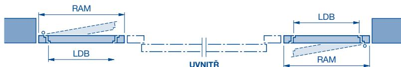
Montáž v otvoru, otvírání ven nebo dovnitř,
